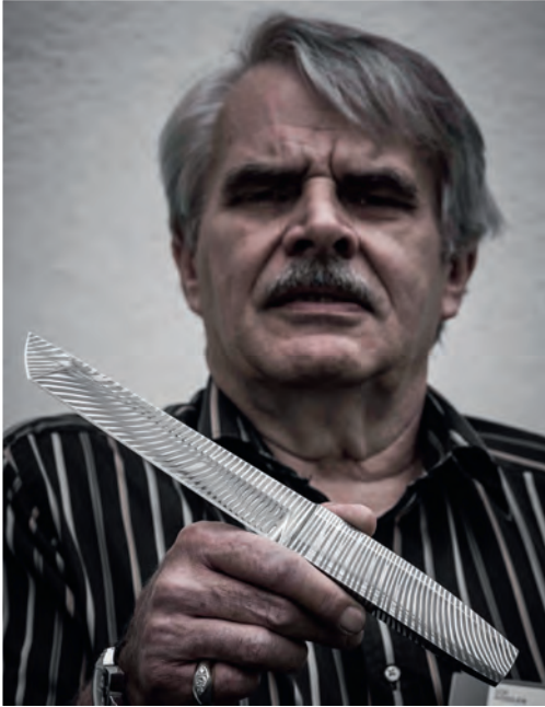
Hans Joachim „Joe“ Pöhler aus Knittlingen schuf einen Streifen-Damast, aus dem er ein Integral-Messer mit tantoähnlicher Klinge fertigte. Keine eigene Website, aber als Präsidenten der Messermacher-Gilde erreicht man ihn über: www.deutsche-messermacher-gilde.de
