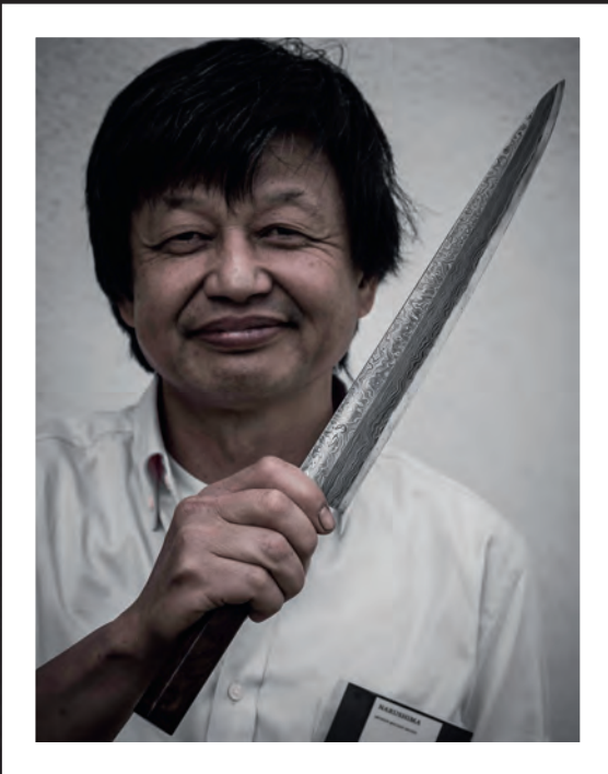
Noriaki Narushima aus Dorfen mit Sashimi-Messer. Die 30-cm-Klinge besteht aus einer harten Schneidleiste, gefasst in elastischem Damaszener-Stahl. Der traditionelle japanische Schliff ist einseitig. Griff aus Chechen-Holz hinter Büffelhorn-Zwinge. www.nori-messer.de
