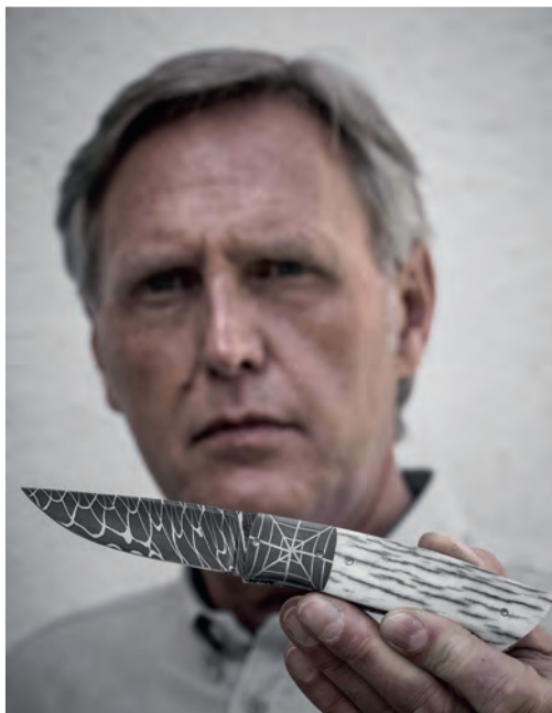
Reiner Grösche aus Werl in Westfalen ist bekannt für feine Herrenmesser aus Heieck-Damast. Backen mit Spinnennetz-Motiv und Griffschalen aus fossilem Horn. Liner aus der Luftfahrt-Titanlegierung Ti6A4V. www.rg-knives.de
