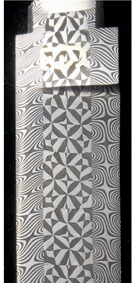
Diese Klinge zeigt drei Bahnen komplexen Damaststahls – ein herrlicher Beleg für das Können der Schmiede.
