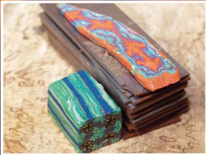
Neue Formen werden zunächst mit Knetmasse ausprobiert. Dazu werden Lagen aus verschiedenen Farben geschichtet und verdreht. Rechts die Bleche, aus denen danach der Damast entsteht.
