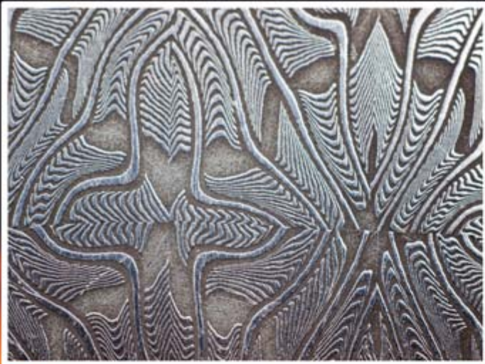
Uwe Heieck schmiedet meist sehr komplex aufgebauten Damast. Die feinen Strukturen aus unterschiedlichem Stahl sind erst unter der Lupe in ihren Details zu erkennen.
